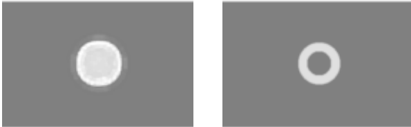
Figure 7 - Bokeh dur (à gauche), bokeh torique (à droite)
