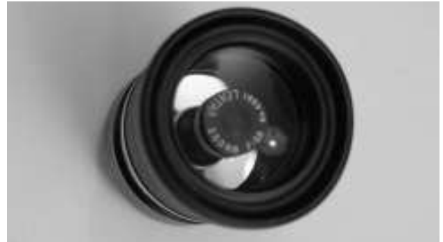
Figure 8 - Optique catadioptrique dit “Cassegrain”, Lentar 5.6/250 mm. La lentille frontale est annulaire, le miroir primaire (annulaire) est au fond, le miroir secondaire est circulaire et placé au milieu de la lentille frontale, le groupe de sortie est placé au fond, au centre du miroir primaire. La tache de bokeh est homothétique de la lentille frontale. Légères et compactes, ces optiques atteignent rarement la qualité et le contraste des optiques traditionnelles, et sont limitées en angle de champ.
