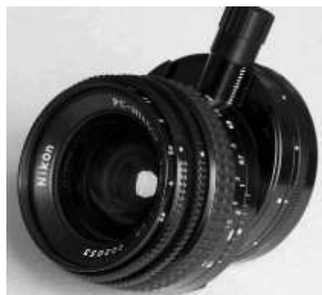
Figure 11 - Optique Nikon PC "perspective correction" à décentrement: ce n'est autre qu'une optique couvrant le moyen format, que l'on promène grâce à une vis micrométrique devant une surface sensible de petit format.
